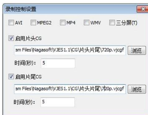
录制控制设置可以选择一键开始录制的录制格式，分别有 **AVI**、**MPEG2**、**MP4**、**WMV**、三分屏录制格式。
