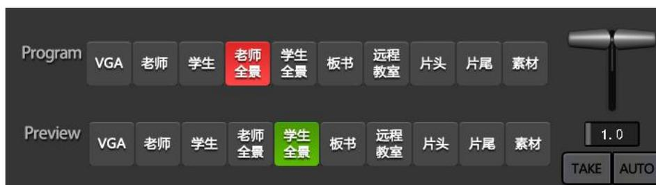
PGM 系列按钮对应每个通道，鼠标点击按钮，PGM 窗口直接硬切到对应的通道内容。PVM 系列按钮对应每个通道，鼠标点击按钮，PVM 窗口直接切换到对应的通道内容。PVM 通道不能切换到与 PGM 通道显示相同的内容。
