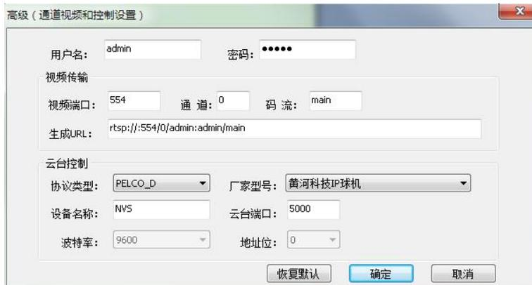
先选择摄像机厂家型号，根据摄像机的连接参数填写“用户名”、“密码”、“视频端口”、“协议类型”、“设备名称”、“云台端口”等参数。云台协议类型目前仅支持 PELCO\_D 和 PELCO\_P。摄像机厂家类型默认支持海康 IP 摄像机和朗驰 IP 摄像机，其它型号摄像机可以在生成 URL 中直接填写它的连接地址。
