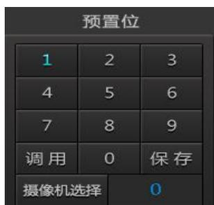
首先用云台控制把摄像头的位置调到合适的位置，然后用选择要保存到预置位的数字，再点击“保存”按钮，即可设置该编号的预置位，点击“调用”按钮可调用该编号的预置位。选择摄像机位，再点击“摄像机选择”可使能对应通道的云台控制。
