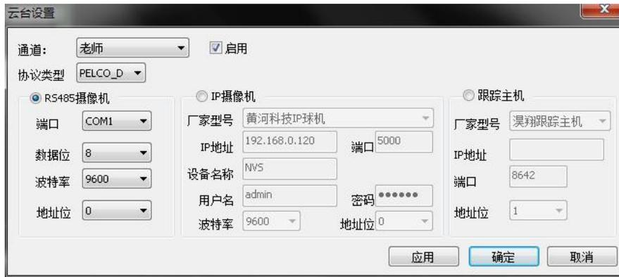
首先选择需要设置的通道，然后选上“启用”复选框。根据接入该通道的摄像机协议类型。
